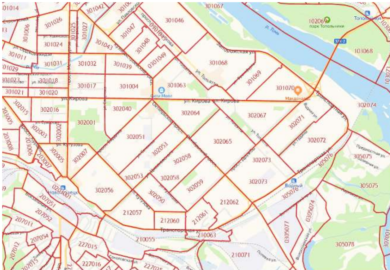
Рисунок 1.2 – Деление территории в генеральном плане городского округа с использованием кадастровых элементов (рисунок П25.1 МУ)
